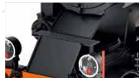
Schütte unter der Rauchkammertüre
