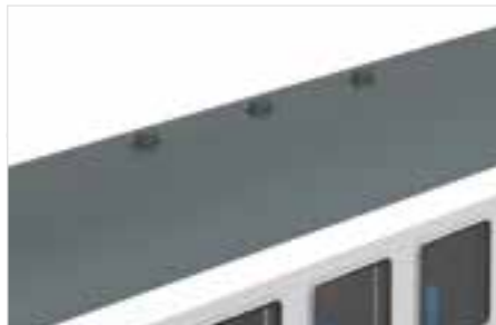
Separat angesetzte WLAN-Antennen
