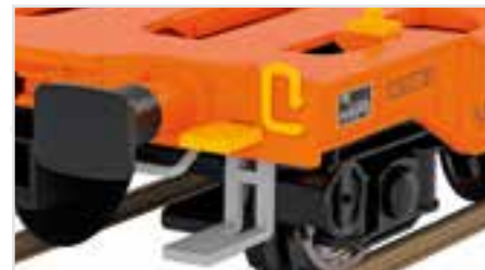
Nachbildung von Griffstangen und Trittstufen
